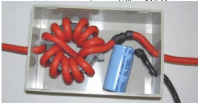
タカチSW-100SプラBOXに収納した製作例
