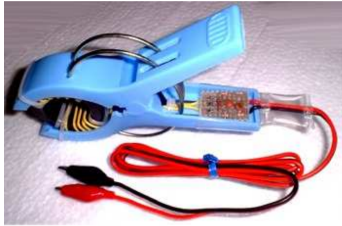
検波部基板をコード中間に配置した 製作例
