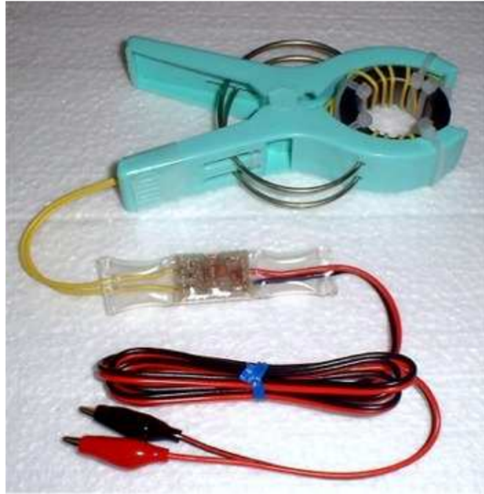
検波部基板をコード中間に配置した 製作例
